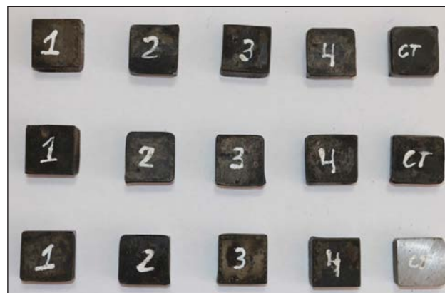
Рис. 1. Дослідні зразки із сталі 65Г
